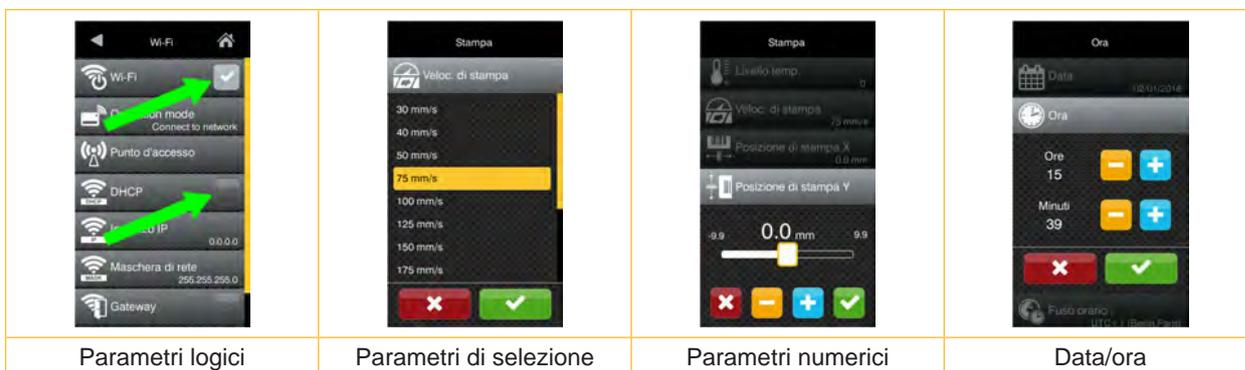
Figura 11 Esempi di impostazione dei parametri
