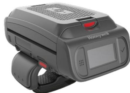
*Il mini computer ergonomico portatile RFID indossabile 8690i fornisce le informazioni essenziali del flusso di lavoro direttamente allo sguardo del lavoratore e consente l'input per supportare i flussi di lavoro più comuni con un singolo dispositivo. L'eliminazione dei movimenti inutili grazie all'ergonomia delle funzioni di lettura RFID e scansione sempre a disposizione migliora l'efficienza dei flussi di lavoro a elevata frequenza.*
